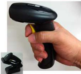
■サイファラボ社のバーコードリーダー製品は、最小分解能が、1Dバーコードで3mil、2Dバーコードで5milとなっており、他社のバーコードリーダーの標準分解能4mil、6milを上回り、読取性能が高く、価格はリーズナブルな設定になっています。
